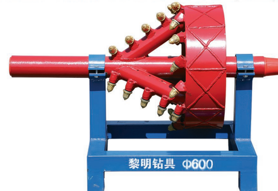
切削式扩孔器 Cutter reamer
